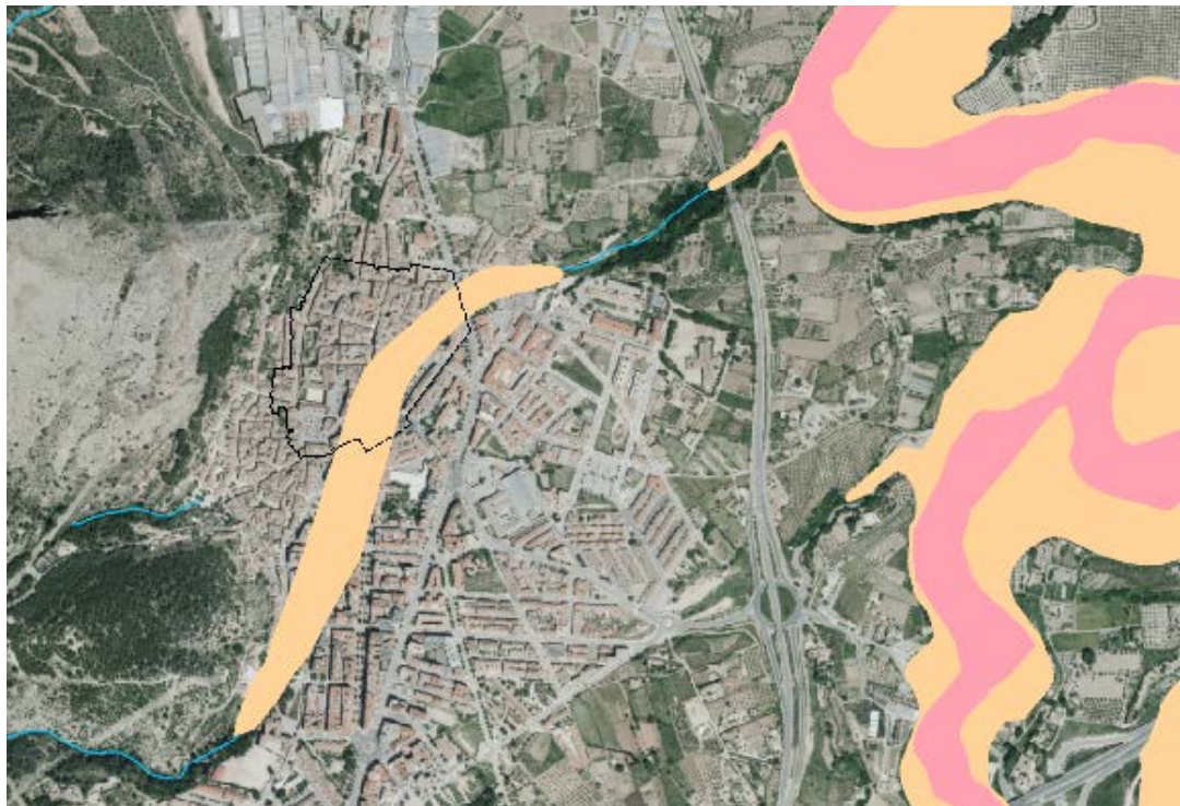
Fig. 06. Zona de peligrosidad de inundación con nivel de peligrosidad geomorfológica en color naranja que atraviesa en ámbito de protección del BIC.
